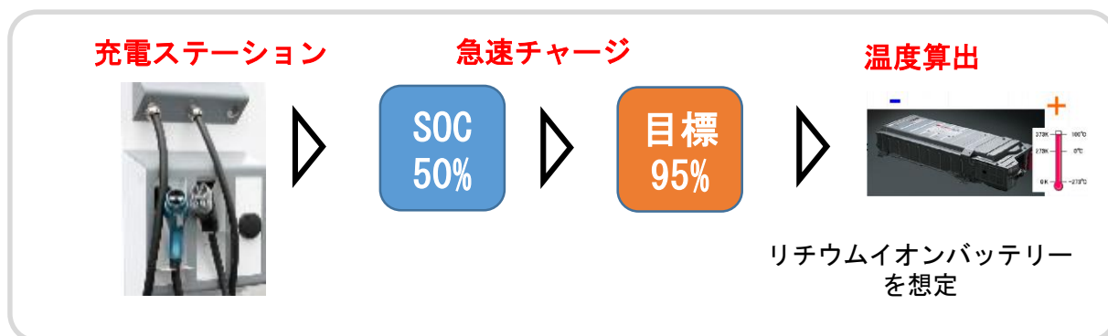
図 2.5.1. 急速充電時のバッテリー温度算出イメージ
